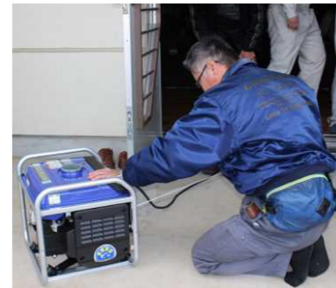
▲非常用発電機
